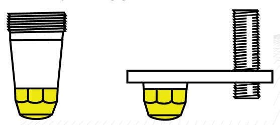
Der Schliff des Diamanten ist in beiden Fällen ballig und soll bei kleinstmöglicher Kontaktfläche eine optimale Auflage auf dem Zylinder gewährleisten.
