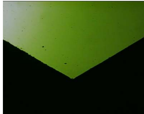
Schneidenausbrüche auch außerhalb des Gravurbereiches durch unsachgemäße Handhabung.
