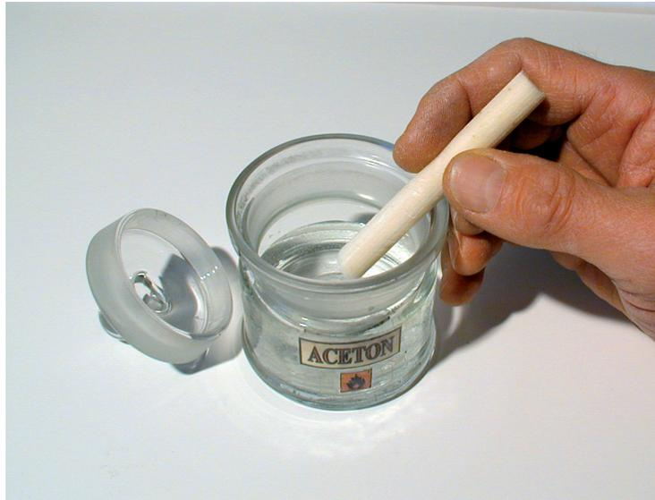
Die frisch geschnittene Stirnseite des Holundermarks wird kurz in Aceton getaucht und ist somit für die Reinigung des Diamanten vorbereitet.
