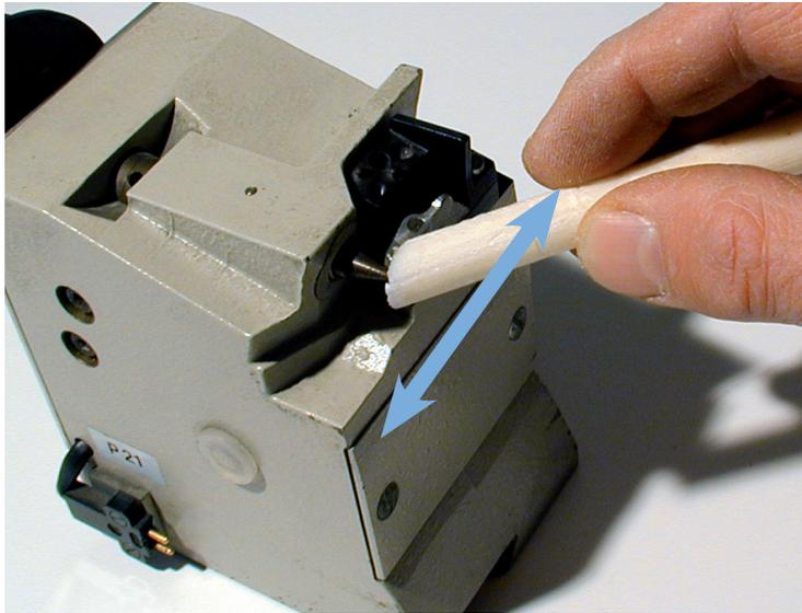
Zur Reinigung des Diamanten wird ausschließlich die Schnittfläche des Holundermarks verwendet.
